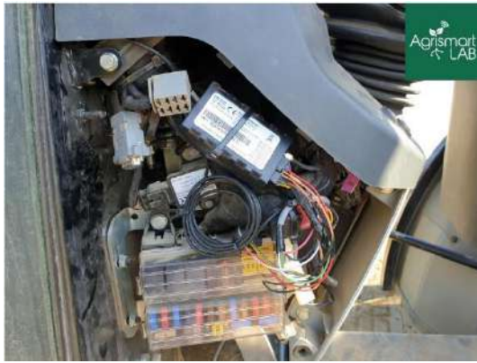
Collegamenti BlackBox e Flussometro
